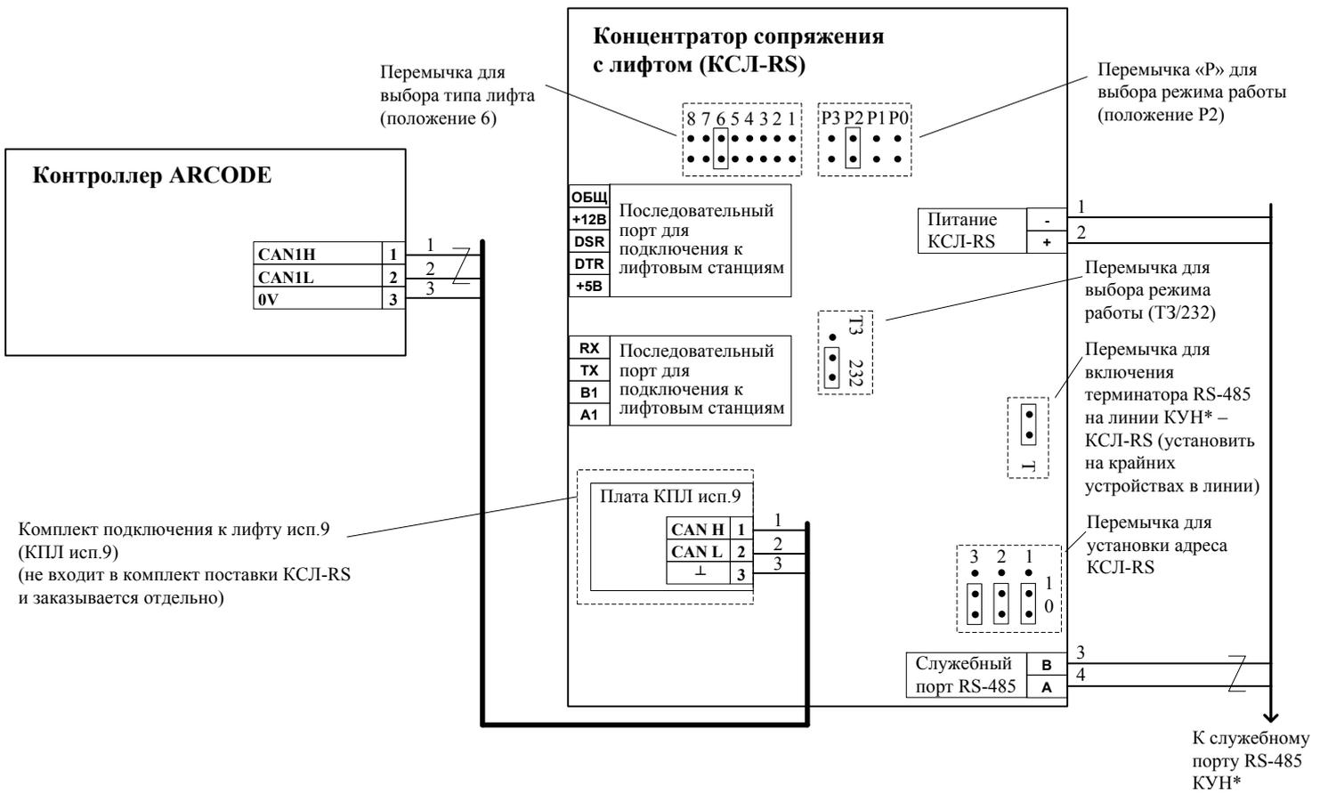
Рис. Б 4.1.21 Схема подключения станции управления лифтом Kleemann (контроллер ARCODE) к КСЛ-RS.
