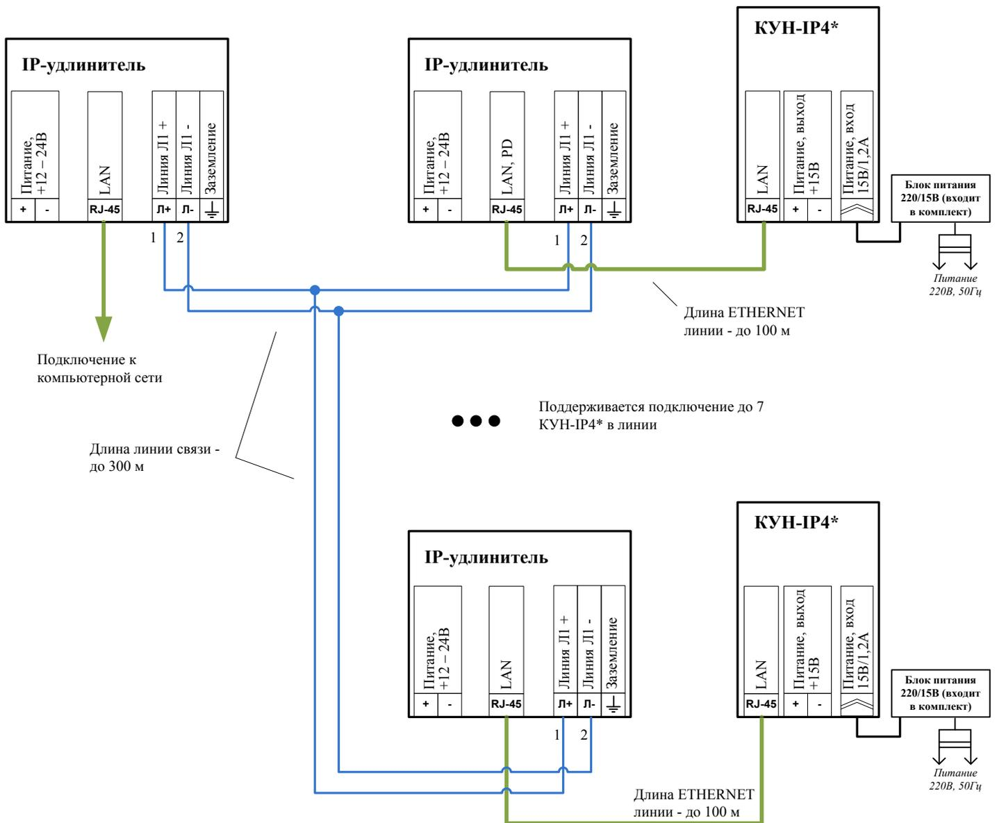
**Рис. Б 3.11.6** Схема подключения КУН-IP4\* с использованием удлинителя – IP. Допускается подключать до 8 IP – удлинителей и 7 КУН-IP4\* в одном сегменте. На одном из КУН-IP4 должны быть установлены перемычки «РОЕ+» «РОЕ-».
