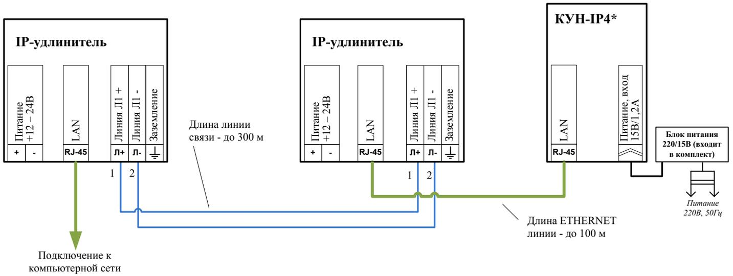
**Рис. Б 3.11.2** Схема подключения IP-удлинителя с питанием PoE (пассивное PoE V) от КУН-IP4 (\*аналогично для КУН-IP8, КИО-1М, КИО-2М, КИО-2MRS)
