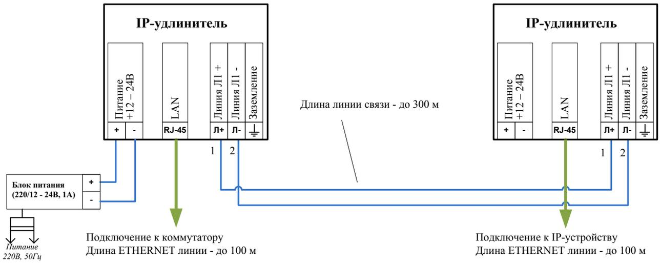
**Рис. Б 3.11.1** Схема подключения IP-удлинителей с питанием от внешнего источника.
