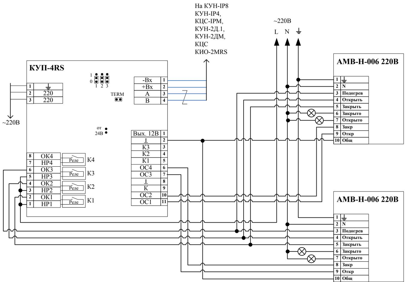
**Рис. Б 4.7.4** Схема подключения к концентратору управляющему КУП-4RS электропривода АМВ-Н-006 220В (арт. 065L8180R).
