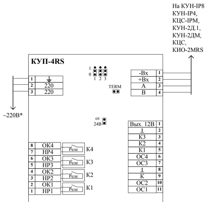
**Рис. Б 2.5.5-2** Схема подключения концентратора управляющего-4 RS (КУП-4RS).
