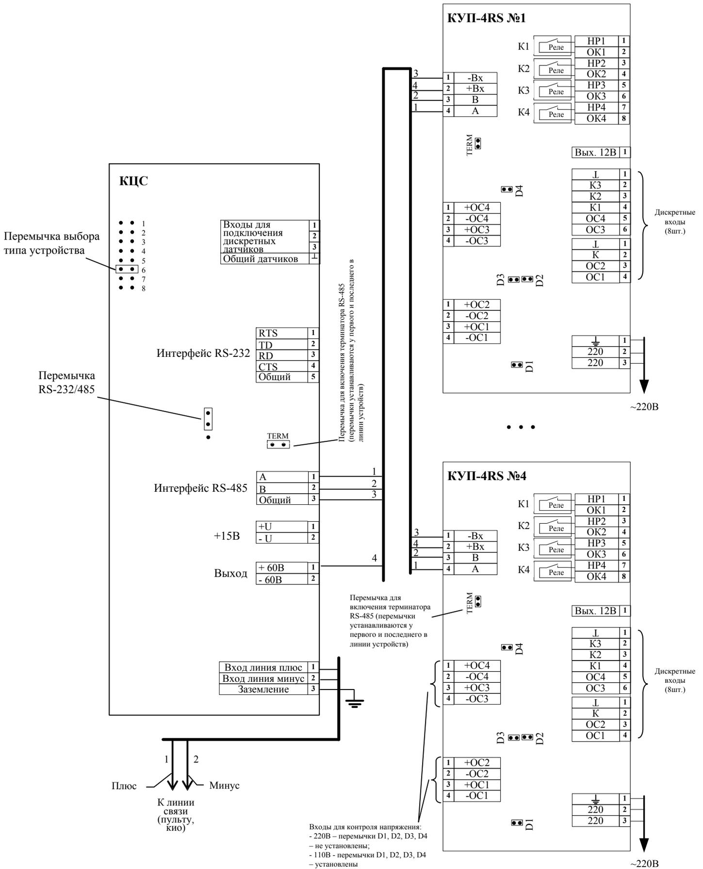
**Рис. Б 2.5.4-4** Схема подключения концентратора управляющего КУП-4RS к концентратору цифровых сигналов КЦС. Схема действительна для КУП-2RS.
