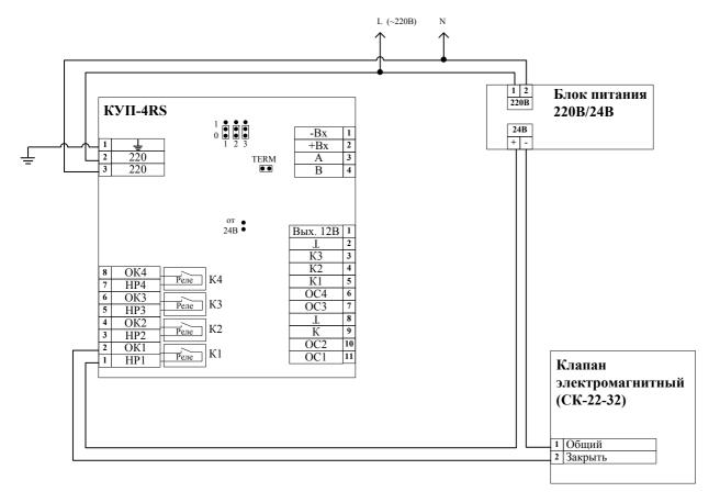
**Рис. Б 4.7.3** Схема подключения концентратора управляющего-4RS (КУП-4RS) и клапана электромагнитного СК-21-32 или СК22-32.
