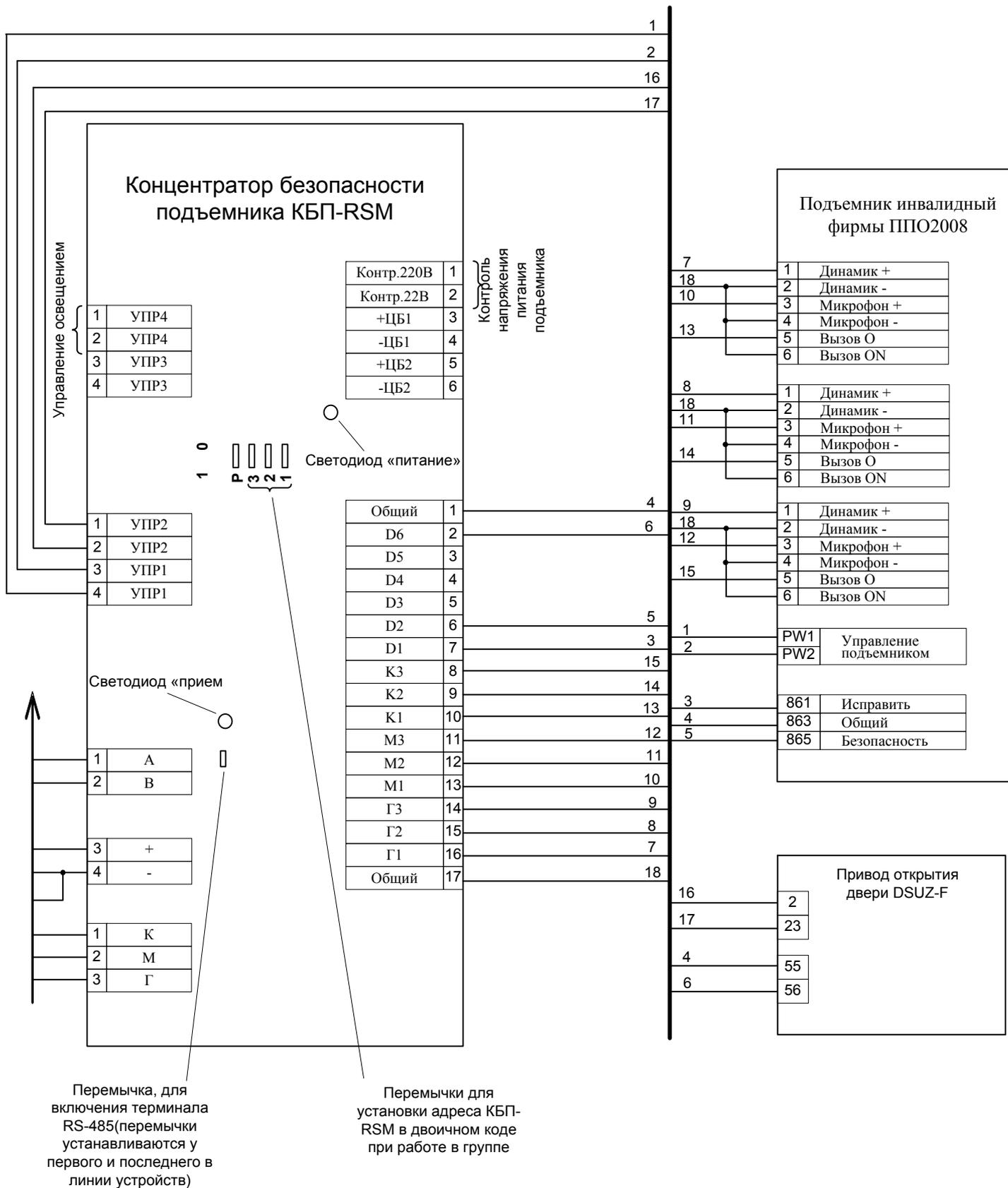
**Рис. Б 4.3.6** Схема подключения концентратора безопасности подъемника KBP-RSM к платформе подъемной ППО2008 Щербинского завода и к приводу открытия двери DSUZ-F. Перемычку «Р» (режим)установить в положение «0»
