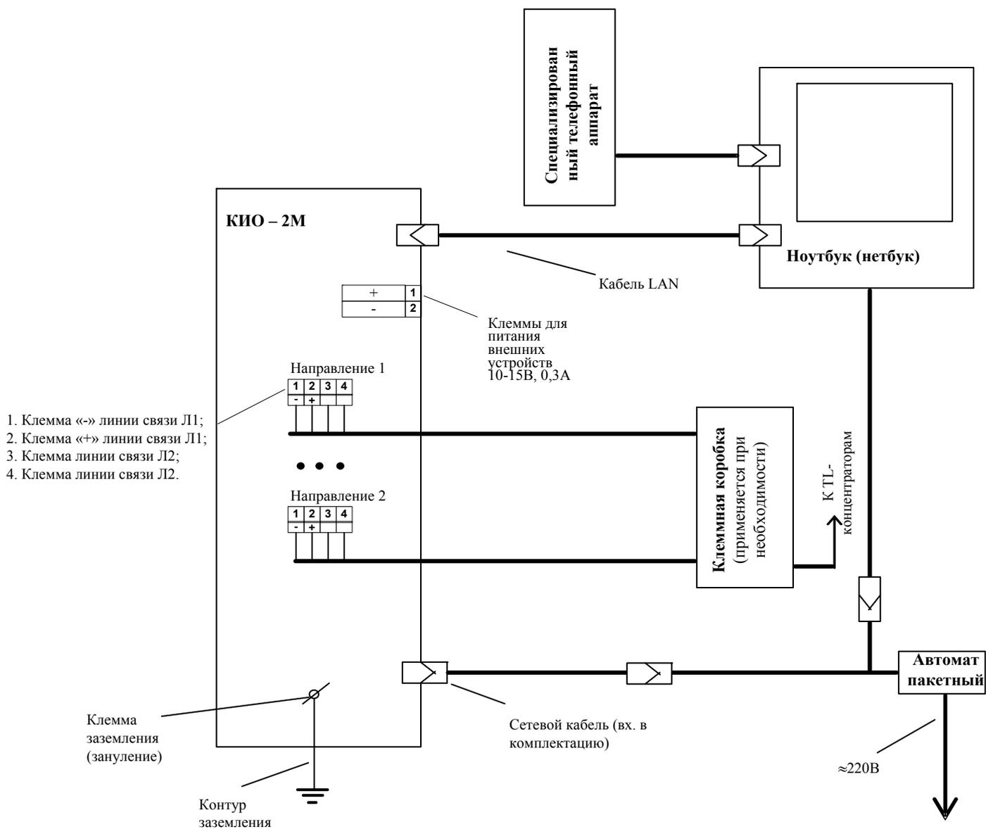
**Рис. Б 1.8** Организация рабочего места диспетчера с использованием КИО-2М, КИО-2МД и ноутбука (нетбука).
