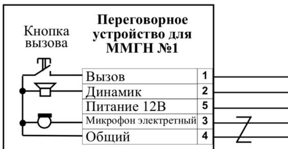
Рис.1. 5-и.проводная схема
